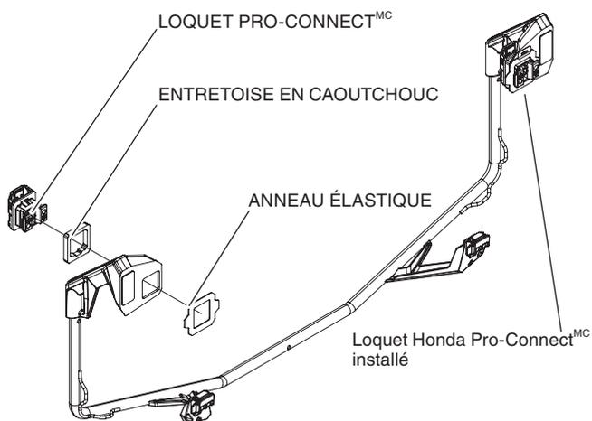
3. Soulevez le levier de chaque loquet jusqu'à ce qu'il se déverrouille. Placez la rallonge de support avant sur le support avant du VTT. Alignez chaque loquet avec chaque orifice correspondant dans le support, puis insérez chaque loquet dans son orifice.
