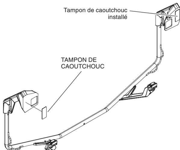
2. Installez deux loquets Honda Pro-Connect<sup>MC</sup> dans la rallonge de support avant en insérant une entretoise en caoutchouc entre chaque loquet et la rallonge de support avant. Fixez les loquets à la rallonge de support avant à l'aide d'un anneau élastique sur chaque loquet depuis le dessous de la rallonge de support avant.
