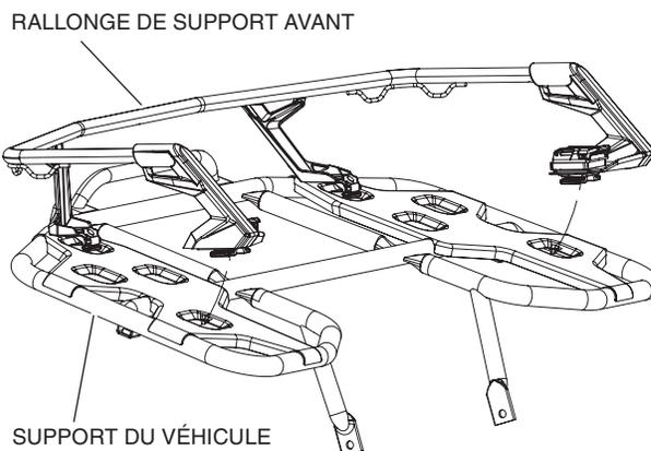
4. Fixez le bac de rangement au véhicule en abaissant le levier de chaque loquet Honda Pro-Connect<sup>MC</sup>.
